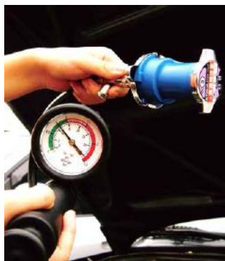
●ラジエーターキャップの作動点検 * キャップテスト用アタッチメント使用
