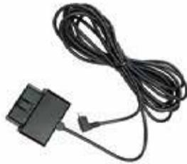
簡易故障診断で車両故障診断情報を取得し、エンジンシステムの故障の有無を表示します。
