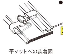
●品質 / (ストッパー本体) ABS樹脂 (ねじ) 鉄 (ワニグチクリップ) 鉄
