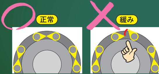
ホイールナットを締めた後、チェックポイントを装着。最初にきれいに装着すると、ナットが緩んだときに違う方向を向くため、それにより緩みがわかります。
