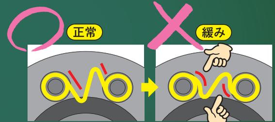
走行による振動や衝撃から起こるナットの緩みを一目で確認することができます。また、樹脂のスプリング性能により、ナットの緩みを防止することができます。
